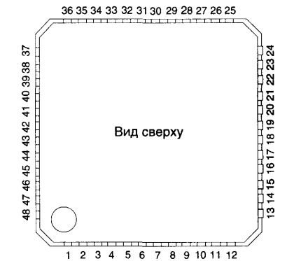
Рис. 13. Расположение выводов микросхемы BRIGHT VE
