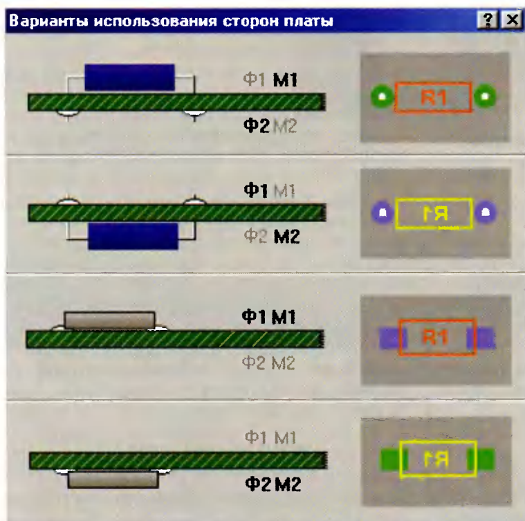
Рис. 2. Варианты использования сторон платы в программе Sprint-Layout 4.0 Rus
